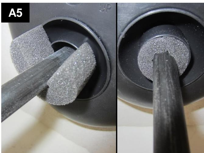
Legen Sie die geschlitzte Dichtung um das Kabel/SNR und in die Kabelaufnahme und achten Sie darauf, dass es keine sichtbaren Öffnungen gibt.
