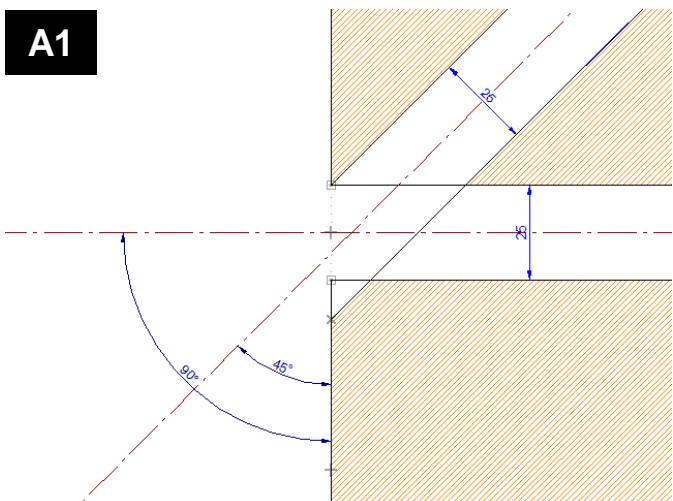
Bohren Sie mit einem Bohrer 25mm durch die Wand. Die Bohrung kann horizontal (90° zur Wand) oder schräg bis zu 45° bei Gebäuden ohne Keller gemacht werden.
